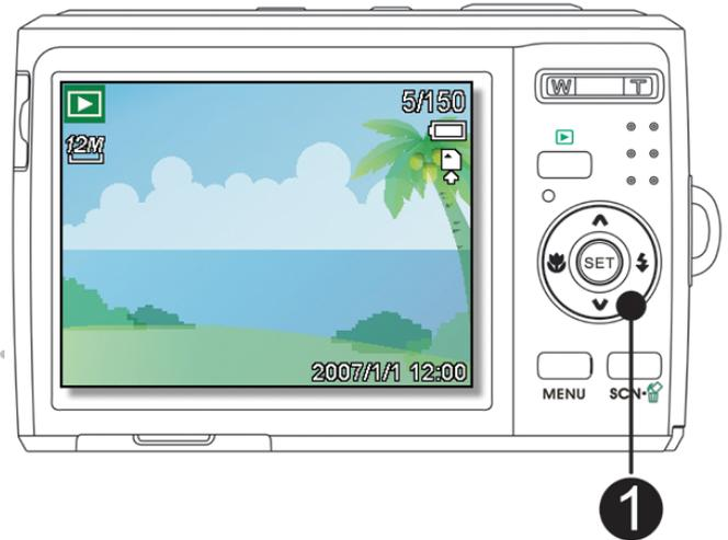
**2** Presione el control de cuatro direcciones ◀ o ▶ (1).
